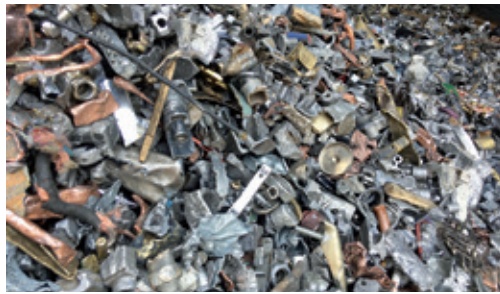
Reines Aluminiumgemisch (TWITCH) nach STEINERT KSSI XT CLI. (Links)
